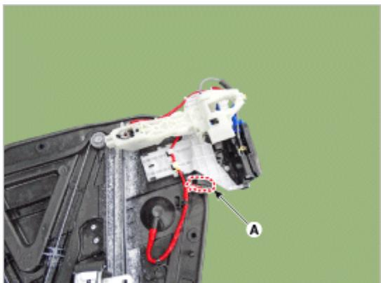
4. 朝箭头方向拉动，拆卸前车门碰锁总成(B)。
