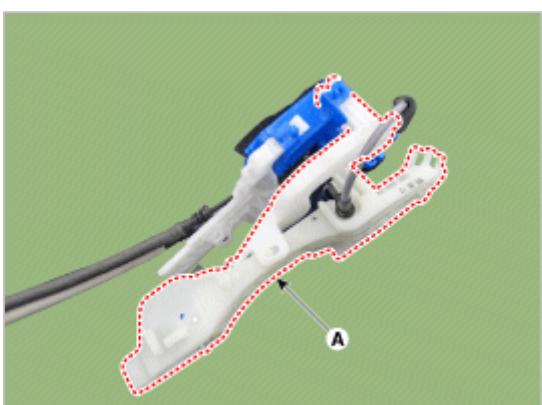
8. 拆卸前车门外侧手柄拉线 (A)。
