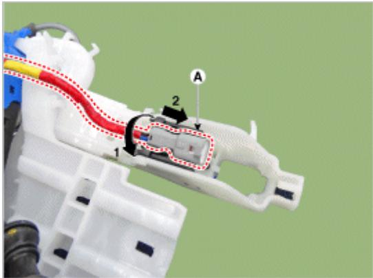
6. 拆卸前车门外侧手柄连接器线束 (A)。
