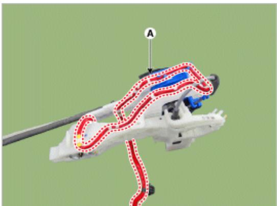
7. 推进位于背面的锁销，拆卸前车门外侧手柄基座 (A)。
