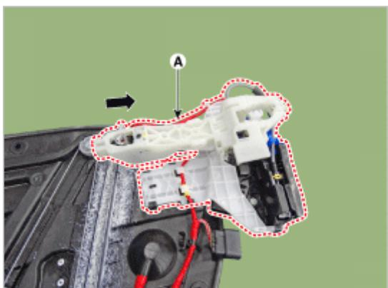
5. 要分离前车门外侧手柄基座连接器(A)，向两侧扩张锁销，并向后推动分离前车门外侧手柄基座连接器。
